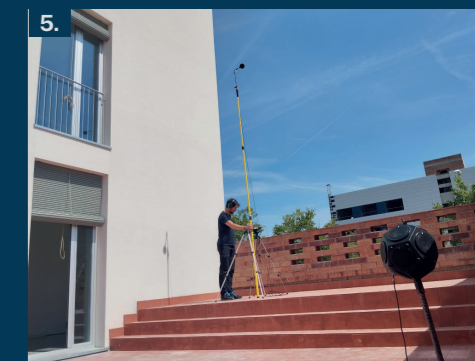
5. Assaig d'aïllament acústic de façana
