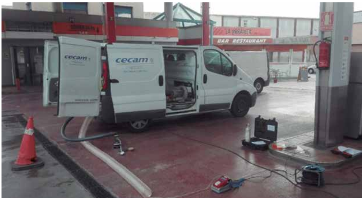
Assaigs d'eficiència (buit) en captadors de vapor.
