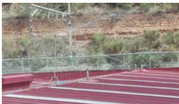
Prova d'estanquitat de coberta mitjançant ruixat per aspersió.
