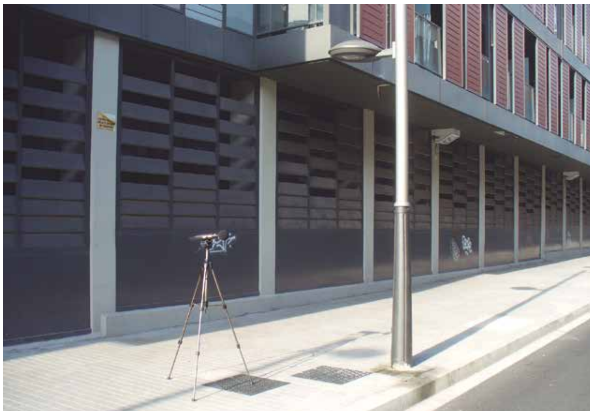
Assaig d'aïllament al soroll aeri d'una façana.
