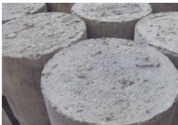
Provetes cilíndriques preparades per a ser trencades.
