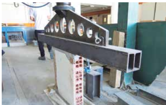
Assaig a compressió d'una paret ceràmica.
