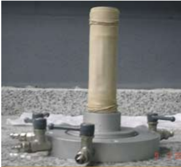
Figura 5: Detall de la mostra col·locada a la base de la cèl·lula triaxial. Aquesta mostra és de 38 mm de diàmetre.
