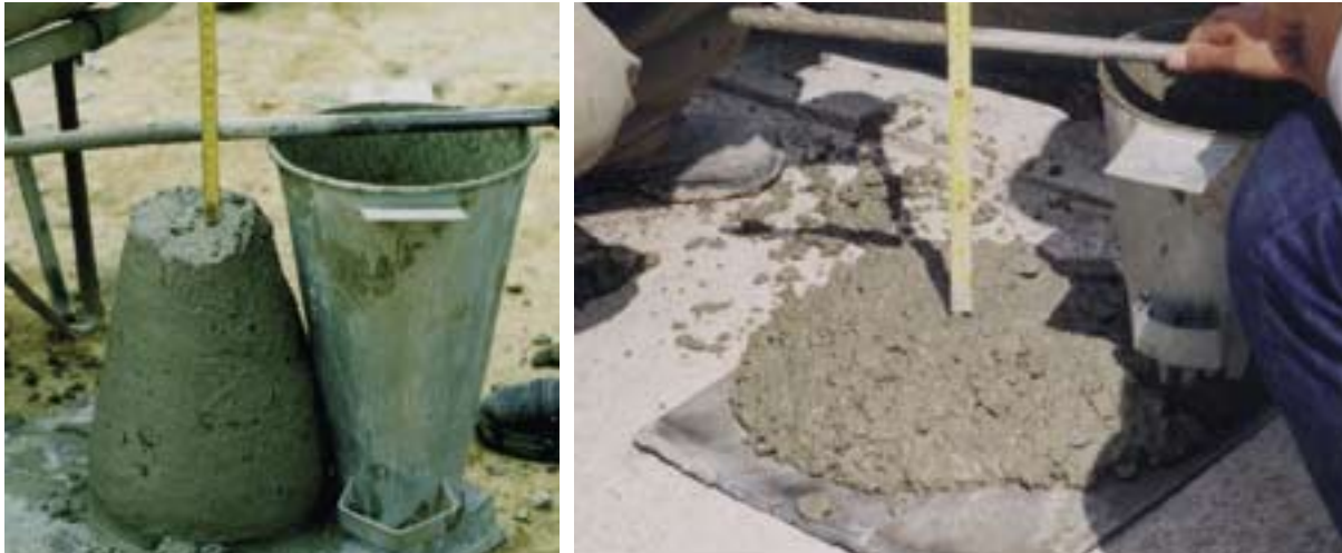
Consistències per un formigó tou (HA-25/B, a l'esquerra) i un formigó fluid (HA-25/F, a la dreta).
