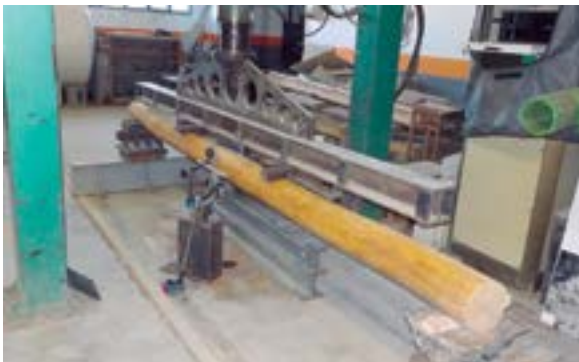
Assaig a flexió d'una biga de fusta.
