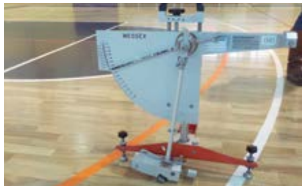
Assaig de lliscament in situ .
