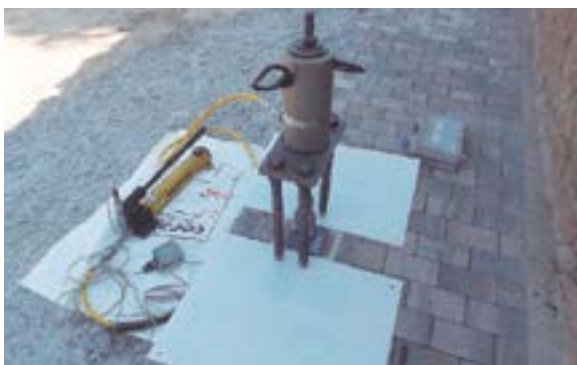
Adherència llamborda de formigó in situ .
