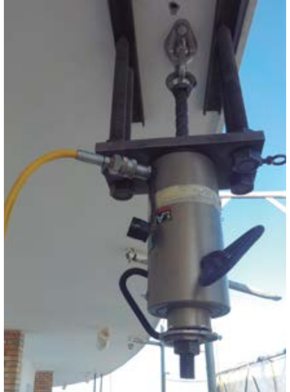
Prova sobre fixacions de seguretat.
