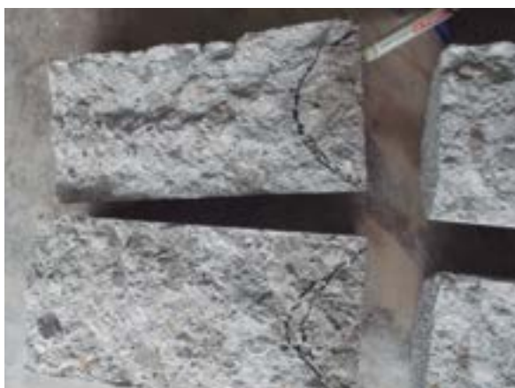
Assaigs de penetració d'aigua.
