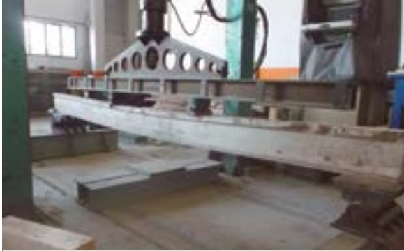
Assaig a flexió d'una biga de formigó.
