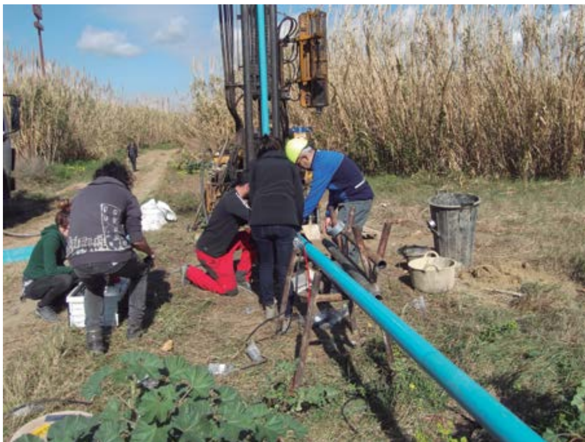
Preparació de l'instrumental associat al tub piezomètric per a l'estudi de la falca marina a Mataró.
