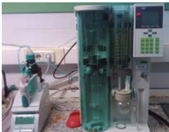
Destil·lador-Valorador Nitrogen Büchi - Metrohm.
