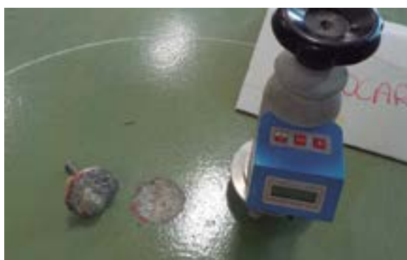
Adherència pintura per tracció.
