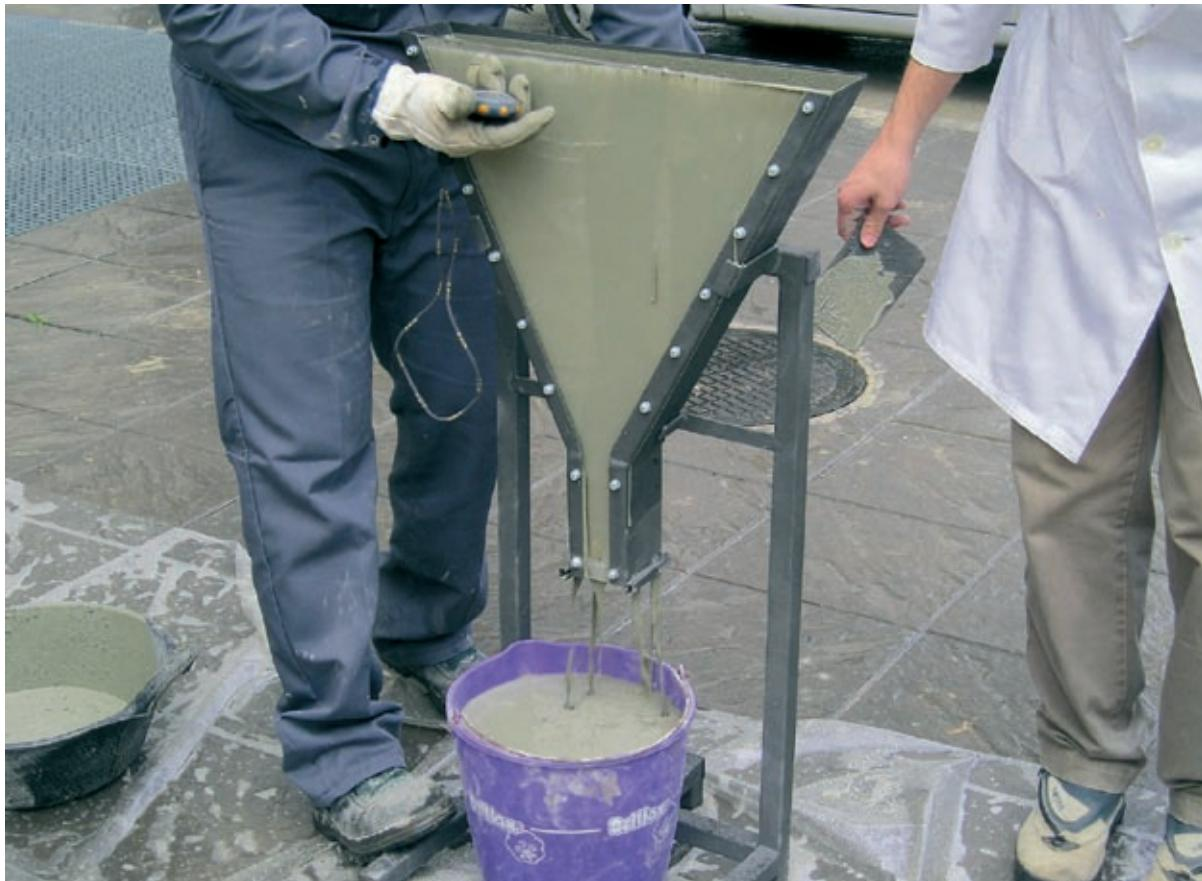
Assaig de treballabilitat per a formigó autocompactant.
