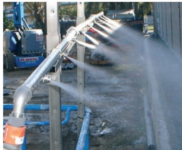
Sistema d'aspersió utilitzat per les proves d'estanquitat on es simula l'efecte de la pluja.
