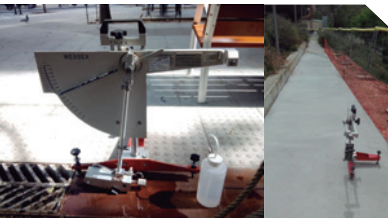
Assaigs de lliscament en obra
