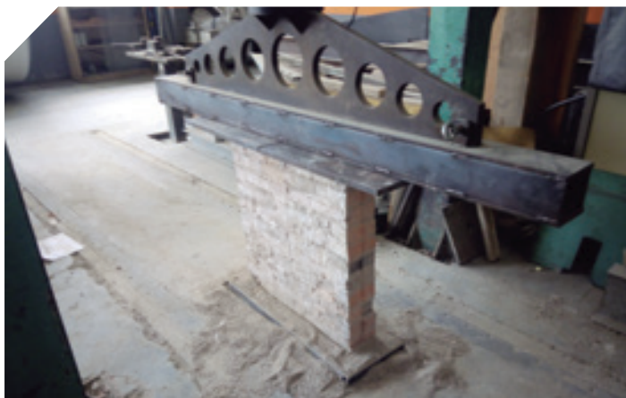
Assaig a compressió d'una paret ceràmica
